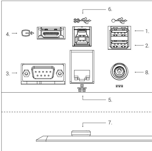
Connecter l'USB 2.0 (voir les options à la page suivante) (1 + 2), boîtier de commande ou commande pédale (3), moniteur (4), ethernet (5), USB 3.0 (6), ESD (uniquement modèles noirs) (7) et alimentation (8) dans cet ordre.
