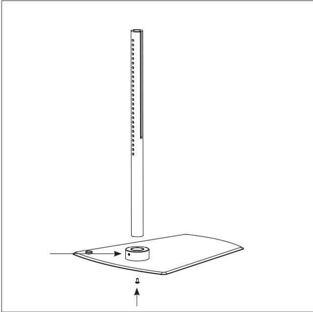
Assemblez la base et la tige avec la vis. Assurez-vous que les trous de la tige sont orientés dans le même sens que le trou de la vis.
