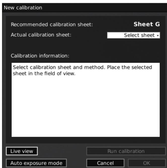
2. Selon le niveau de zoom actuel et la lentille grand-angle, l'application recommandera une feuille d'étalonnage pour l'étalonnage. Placez la feuille de calibration recommandée directement sous votre microscope, de sorte que la rangée supérieure de points soit visible
