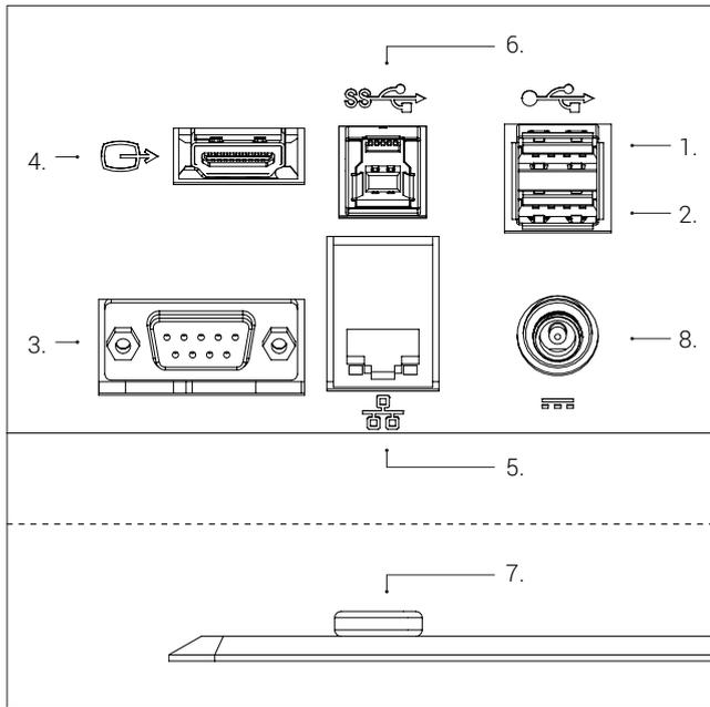
USB 2.0 (siehe Optionen unten) (1+2), Steuerkasten (3), Monitor (4), Ethernet (5), USB 3.0 (6), ESD (nur schwarze Modelle) (7) und Stromquelle (8) in dieser Reihenfolge anschließen.
