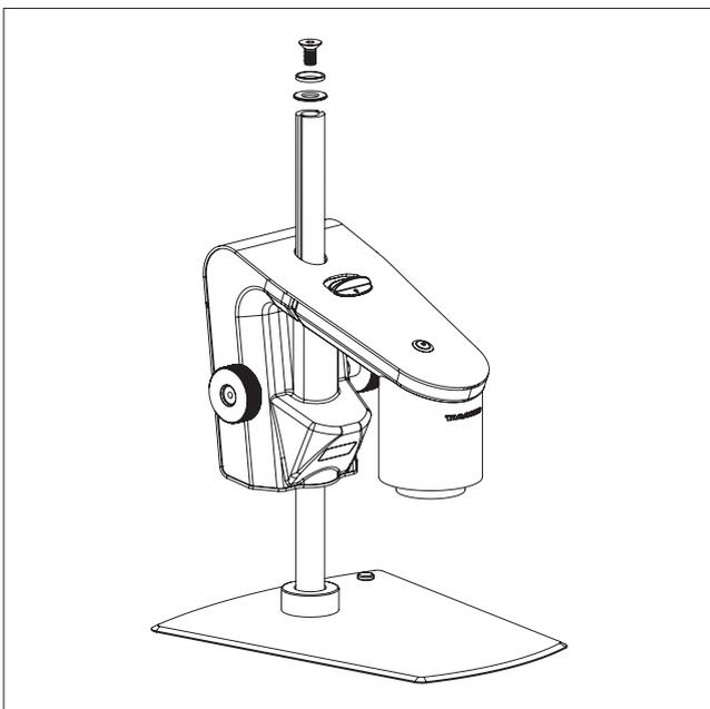
Die Anschlagschraube am oberen Ende der Stange festschrauben
