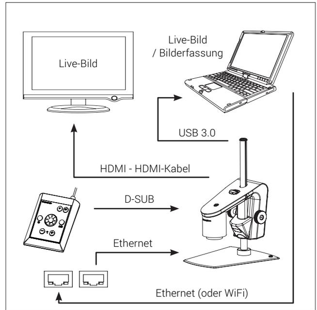
Das Mikroskop kann direkt an den Monitor angeschlossen werden.
