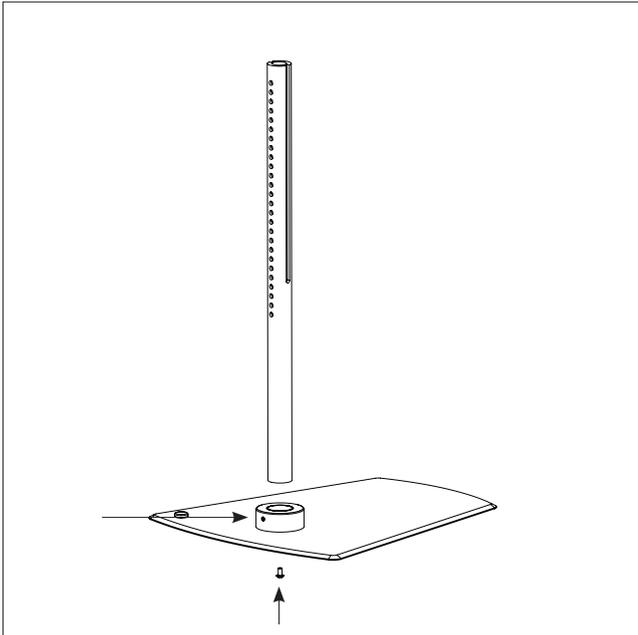
Verbinden Sie Fuß und Stange mit Stoppscheibe und Schraube. Ziehen Sie die Stange sowohl senkrecht unter dem Fuß als auch waagrecht oben auf dem Base fest
