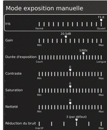
Ces paramètres seront également activés en mode d'exposition automatique. Sinon, la compensation d'exposition est le seul paramètre visible. L'iris, le gain et le temps d'exposition seront automatiquement ajustés aux paramètres recommandés et ne peuvent pas être ajustés dans ce mode.
