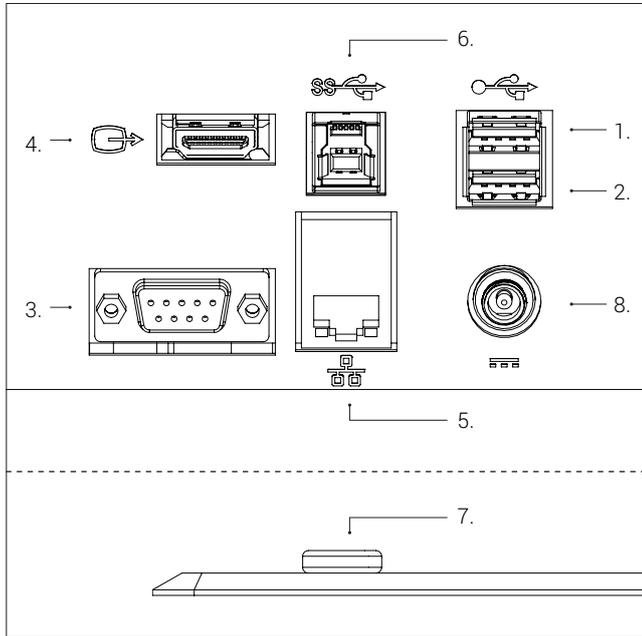
Connecter l'USB 2.0 (voir options ci-dessous) (1 + 2), boîtier de contrôle (3), moniteur (4), ethernet (5), USB 3.0 (6), ESD (uniquement modèles noirs) (7) et alimentation (8) dans cet ordre.
