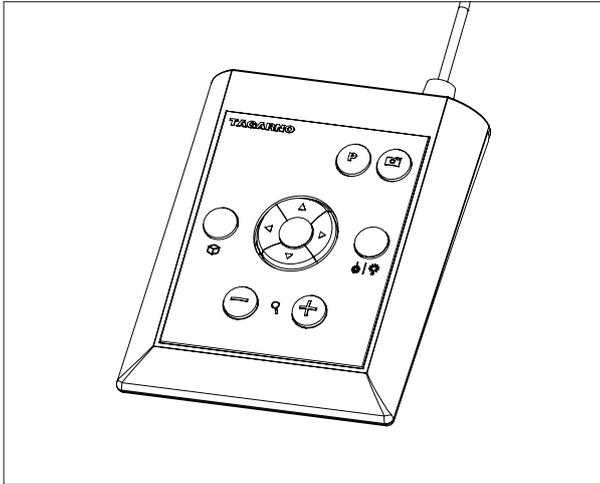
Boîtier de commande XPLUS FHD pour les fonctions du TAGARNO FHD. Connectez seulement des équipements distribués par TAGARNO.
