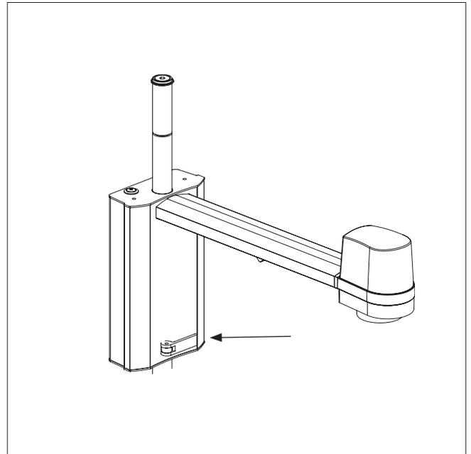
Verrouillez le bras à caméra à la hauteur de l'anneau qui correspond à la lentille utilisée
