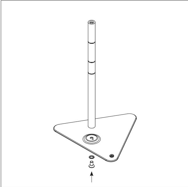
Assemblez la base et la tige avec la rondelle d'arrêt et la vis.
