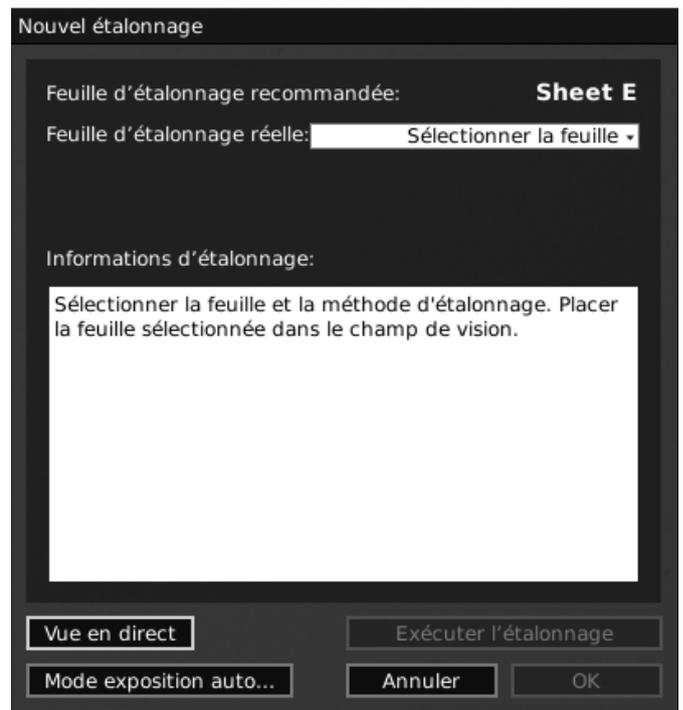
3. Selon le niveau de zoom actuel et la lentille grand-angle, l'application recommandera une feuille d'étalonnage pour l'étalonnage. Placez la feuille de calibration recommandée directement sous votre microscope, de sorte que la rangée supérieure de points soit visible
