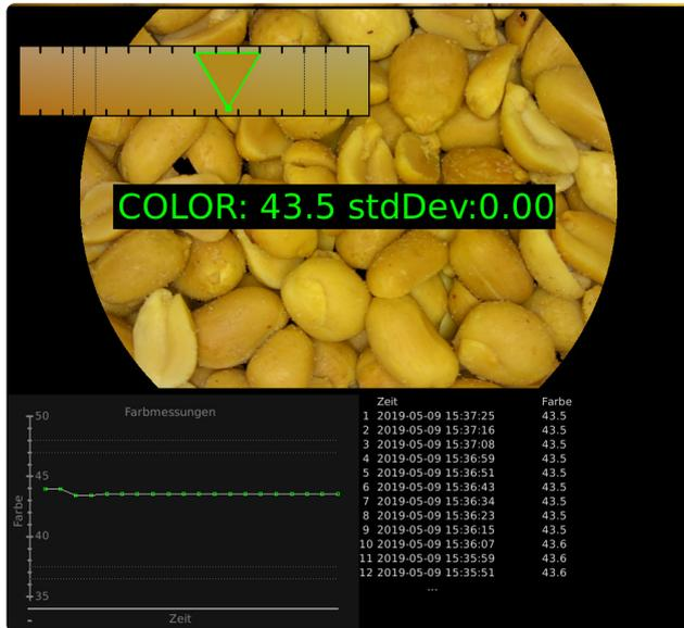
Der durchschnittliche Farbwert der Probe wird auf den Bildschirm geschrieben und auf dem definierten Farbbereich (oben links) in grün angezeigt, wenn er innerhalb der definierten Pass-Grenzwerte liegt. Die Standardabweichung wird ebenfalls gezählt.
